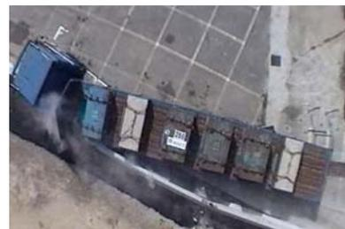
Se requiere la realización de varios **ensayos de impacto reales (Crash-Test)** para cada modelo y nivel de contención.
